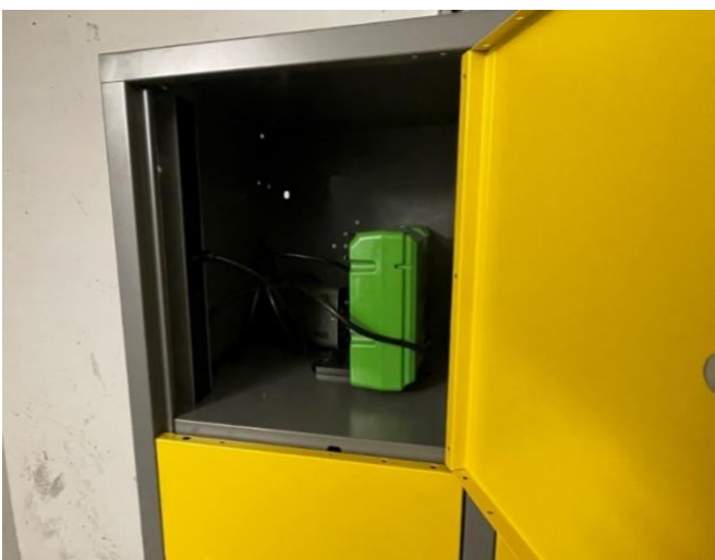
Abbildung 19 – Blick in ein geöffnetes Schließfach mit entnehmbarer Batterieeinheit
