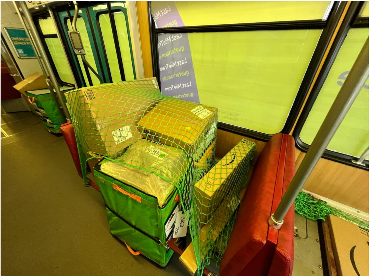
Abbildung 23 - Entfernte Sitzflächen der Sitzbänke im P-Wagen, Pakete nur testweise fixiert, keine finale Befestigung im Zusammenhang mit dem Transport
